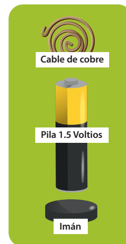
Figura 7. Circuito formado por el imán, la pila y el alambre de cobre en forma circular.
