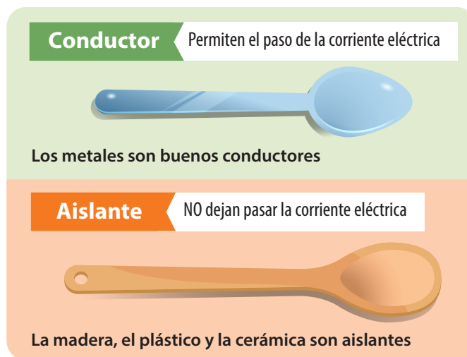
Figura 3. Ejemplos de materiales conductores y aislantes.
