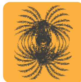
Imagen 5. Campo visto utilizando limaduras de hierro.
