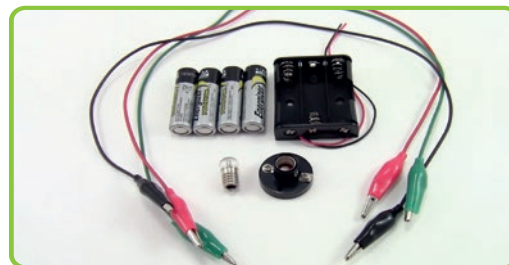
Figura 1. Materiales para la construcción del circuito.
